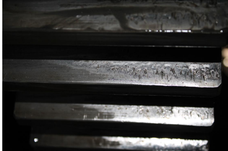
Imagen 23: Desgaste abrasivo en piñón.
