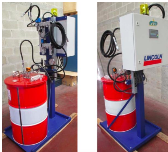
Imagen 43: Bomba SAF2-YL instalada con soporte con cabestrante.
