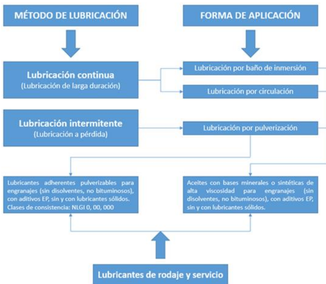
Imagen 24: Esquema de la relación entre lubricante y método de aplicación.
