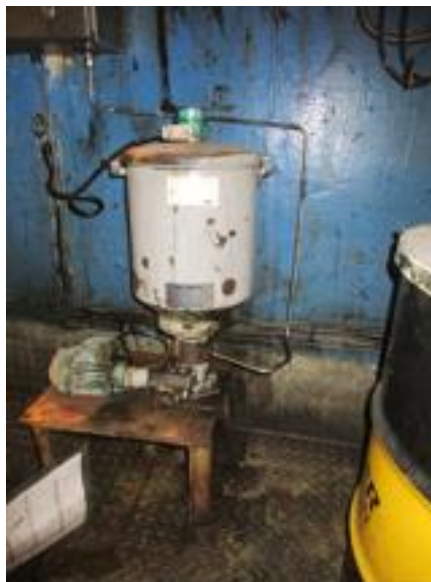
Imagen 31: Bomba neumática con depósito de 30 litros de capacidad.
