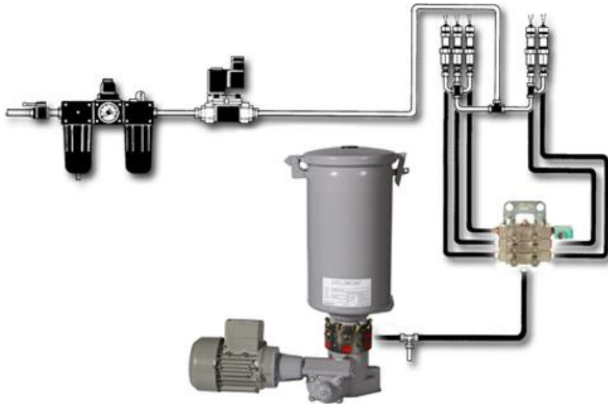
Imagen 18: Sistema de bombeo del mecanismo piñón corona.
