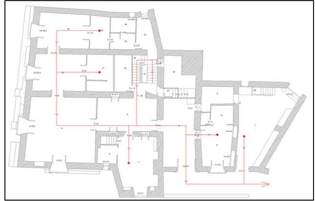
Imagen 74. Recorrido de evacuación planta baja.
