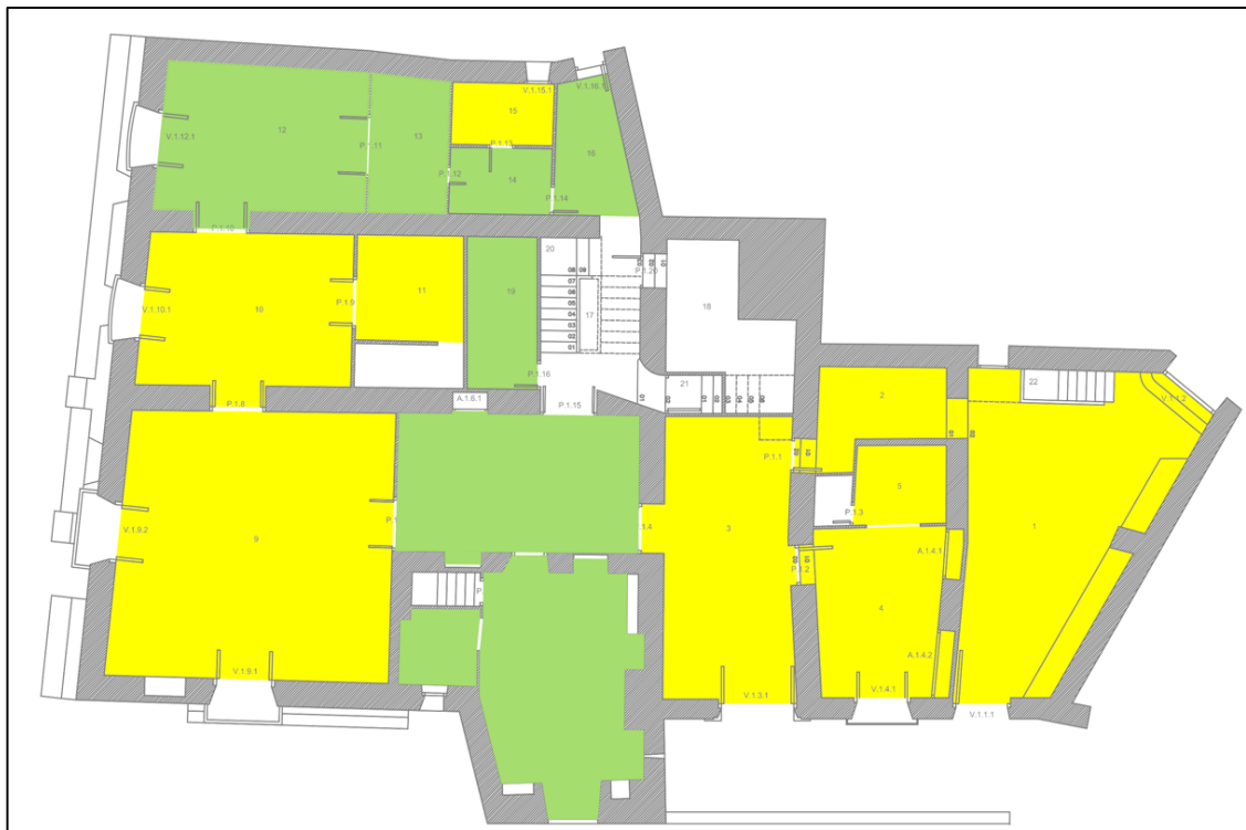
Imagen 78. Grafismo de estado de forjado. Planta baja
