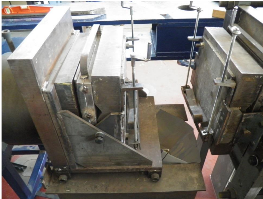
Figura 30. Apoyos del banco de ensayos
