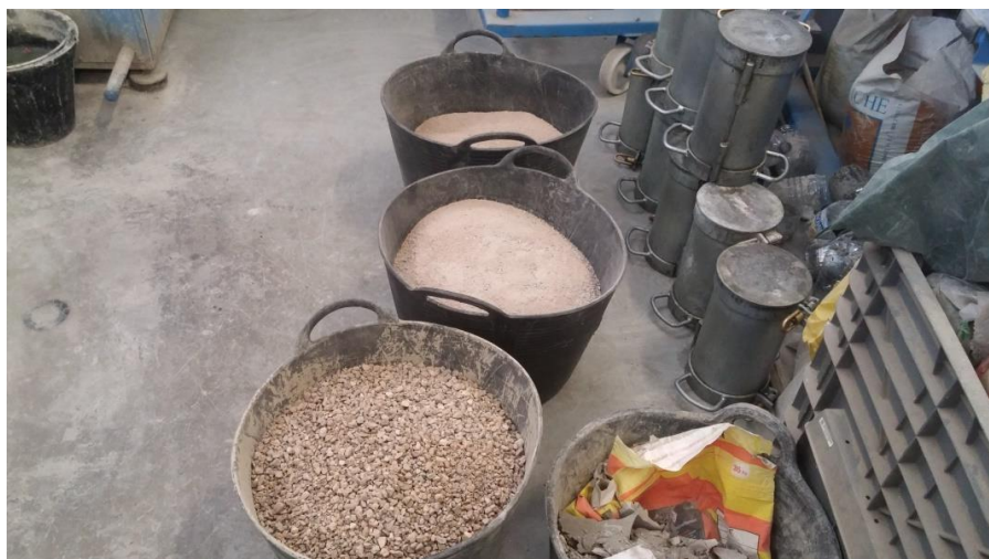
Figura 27. Preparación de los componentes según la dosificación
