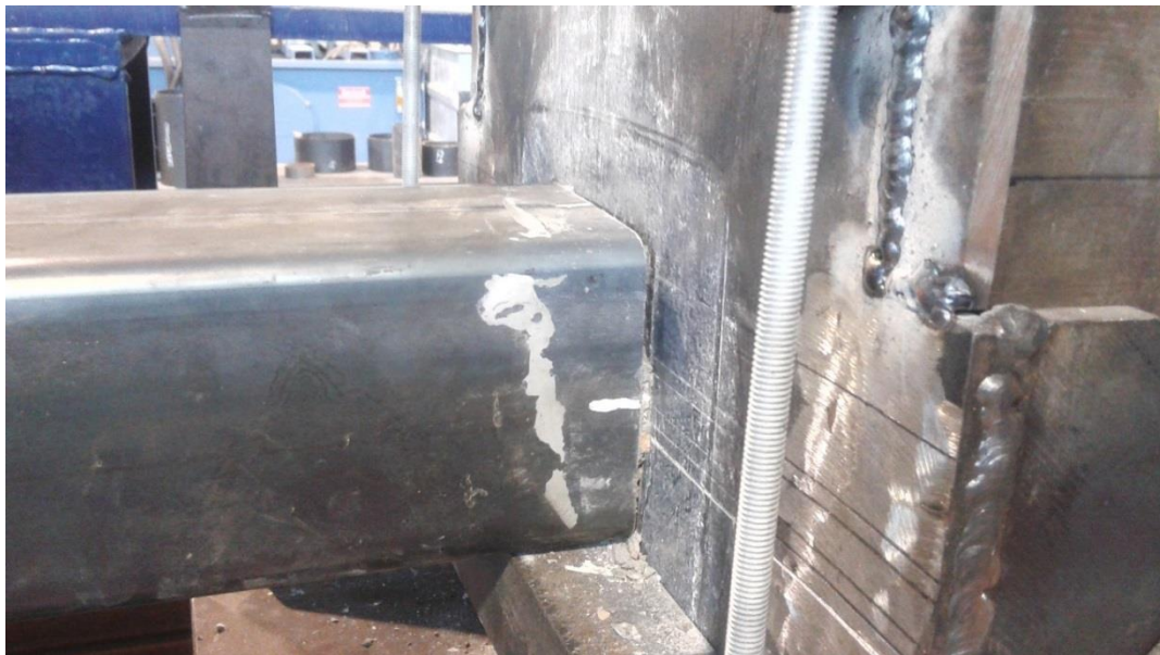
Figura 37. Alineación de los apoyos según la excentricidad
