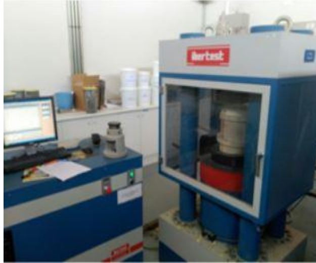
Figura 32. Pórtico para probetas de hormigón
