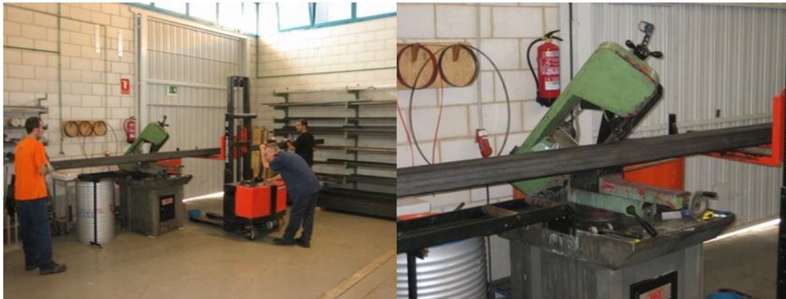
Figura 29. Proceso de corte de los tubos. Hernandez-Figueirido, 2012 [20]
