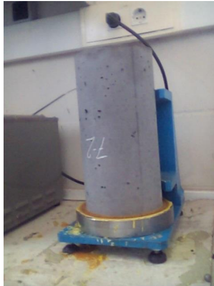
Figura 28. Refrentado de una probeta
