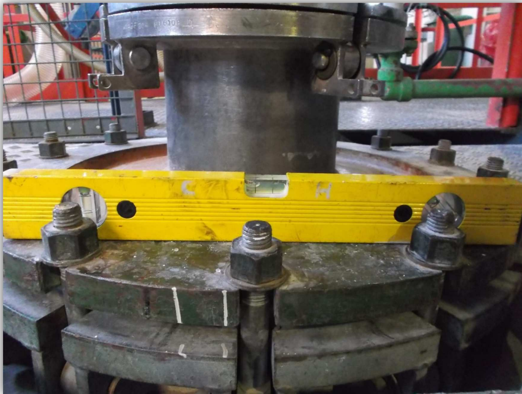
Figura 7.4.2.2.- Desnivel de la boca de carga una vez detenido el secador.
