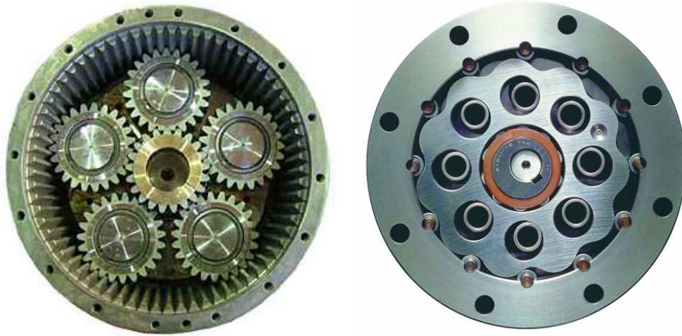
Figura 8.3.2.2.- Mecanismo interno de reductoras epicicloidales con engranajes (izquierda) y con cilindros (derecha).
