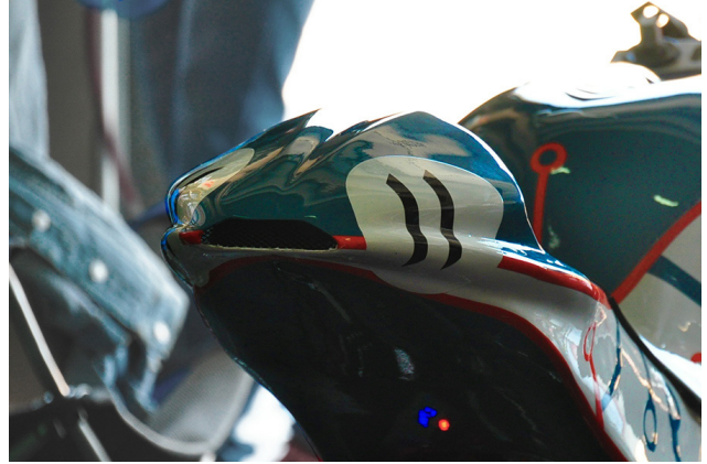
Fig. 85 Detalle de la extracción de aire
