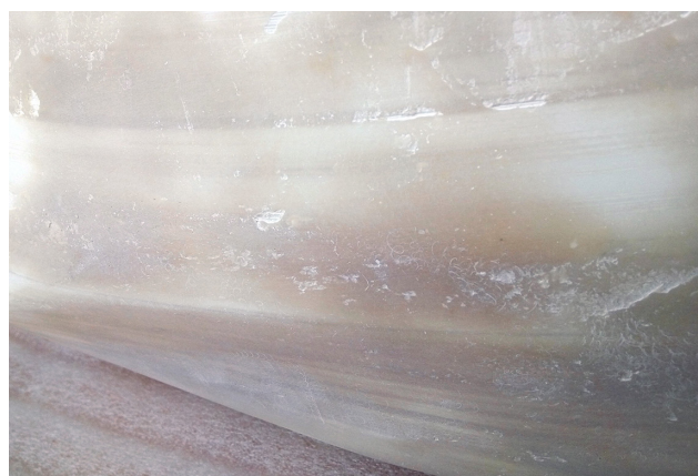
Fig. 119 Detalle superficial de oquedades tras la primera capa y lijada de FV
