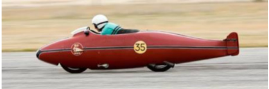
Fig. 13 Replica de la Indian Scout de record de velocidad de Burt Munroe. Donde vemos la importancia de la forma posterior de la motocicleta.
