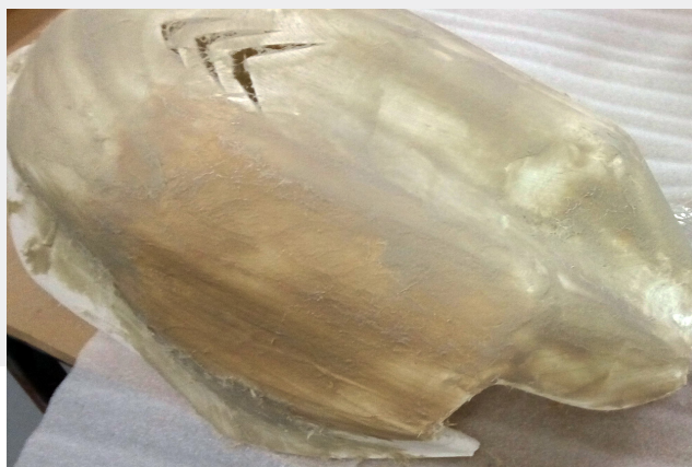
Fig. 116 Detalle de la primera capa de masilla de FV sin lijar en el depósito
