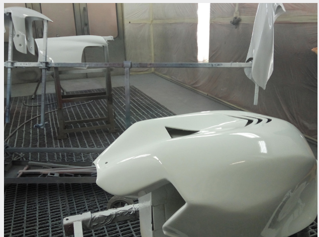
Fig. 123 Secado de la imprimación con color base.
