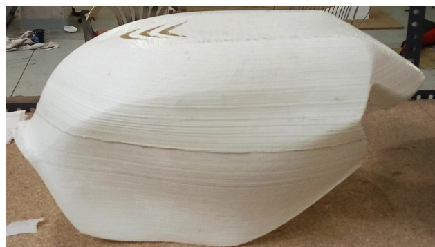
Fig. 113 Detalle de unión exterior del depósito, entre dos partes dividido por una línea horizontal marcada
