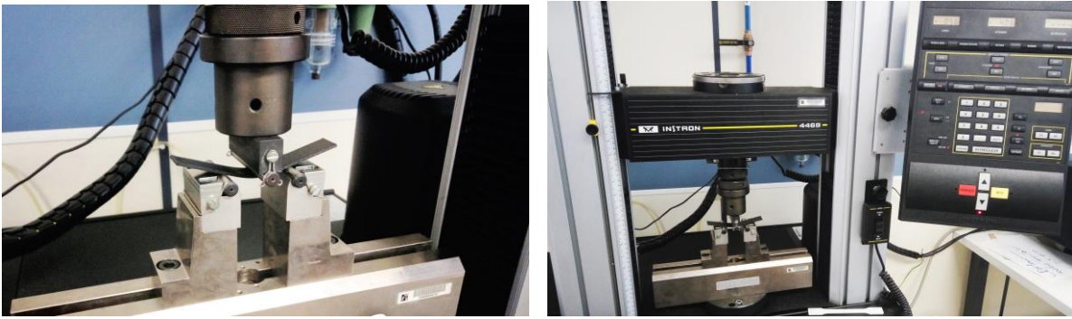
Fig. 165 Ensayo a flexión de las probetas.
