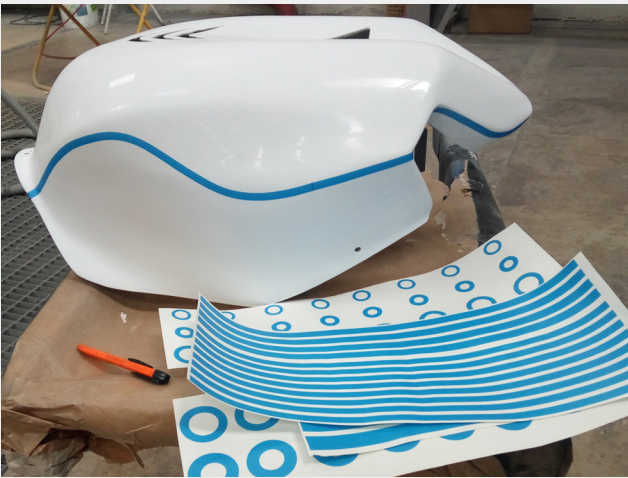
Fig. 124 Colocación de las máscaras en la superficie matizada.
