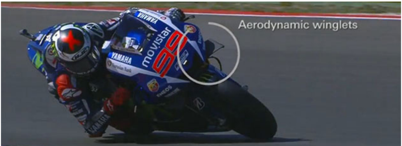
Fig. 15 Alerones instalados en motocicletas de Moto GP con el fin de contrarrestar el momento aerodinámico.
