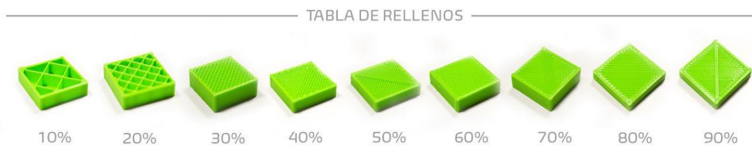
Fig. 163 Rellenos de piezas fabricadas por FDM.
