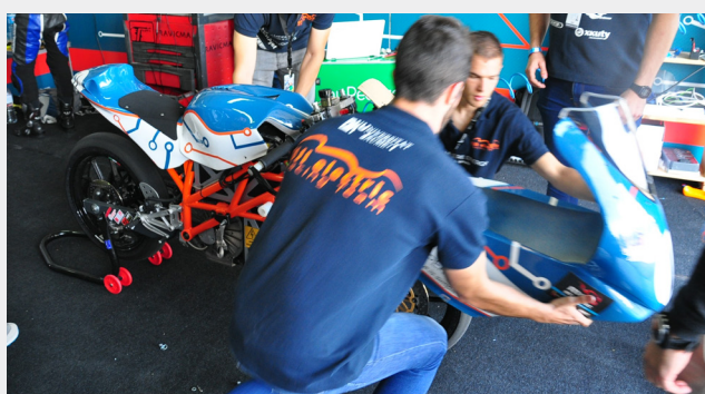
Fig. 132 Desmontaje rápido del carenado frontal.
