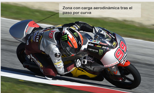
Fig. 86 Carga aerodinámica tras paso por curva.
