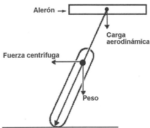
Fig. 17 En teoría, un alerón que se pudiera inclinar para mantenerse siempre horizontal, podría mejorar la frenada, la tracción y la velocidad de paso por curva
