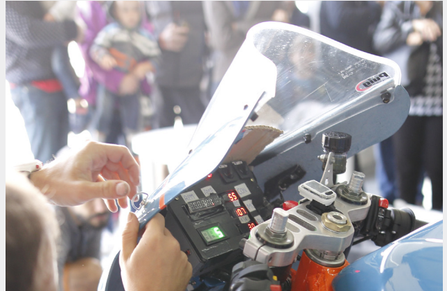
Fig. 134 Extracción de la tornillería rápida del carenado frontal.
