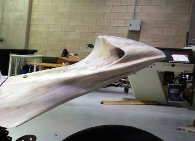
Fig. 120 Detalle del colín preparado para el aparejado. En el se visualizan dos tipos de masilla, de FV con tonos grises, de poliéster con tonos beige.
