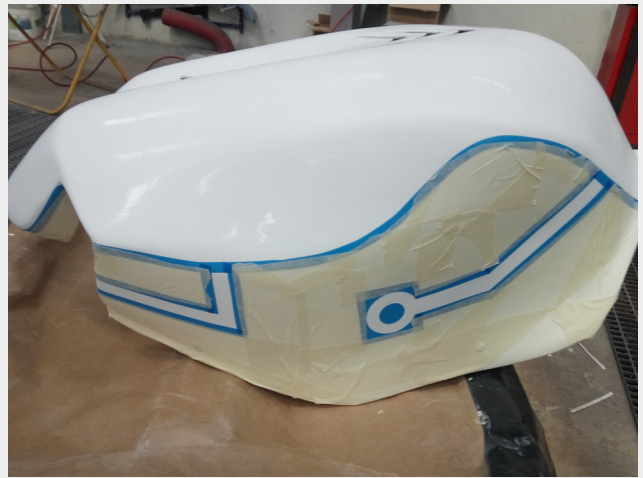
Fig. 125 Recubrimiento de la superficie para conservar el color base.
