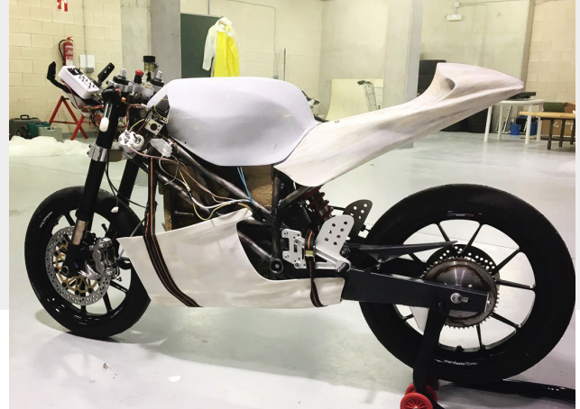
Fig. 121 Proceso de acoplaje de la quilla al chasis.
