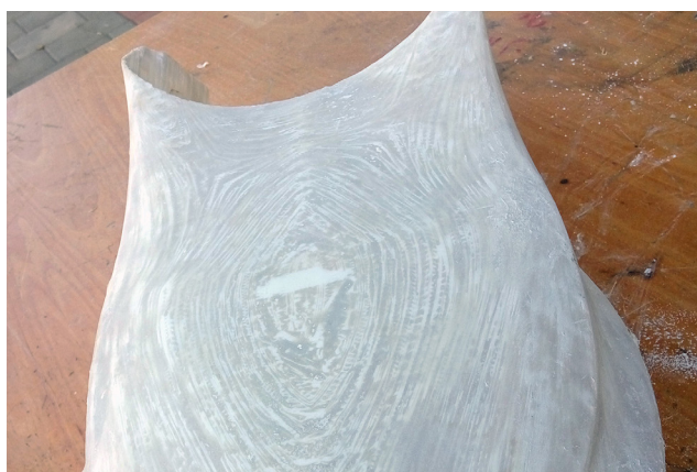
Fig. 118 Detalle superficial tras el lijado de la primera capa de masilla de FV
