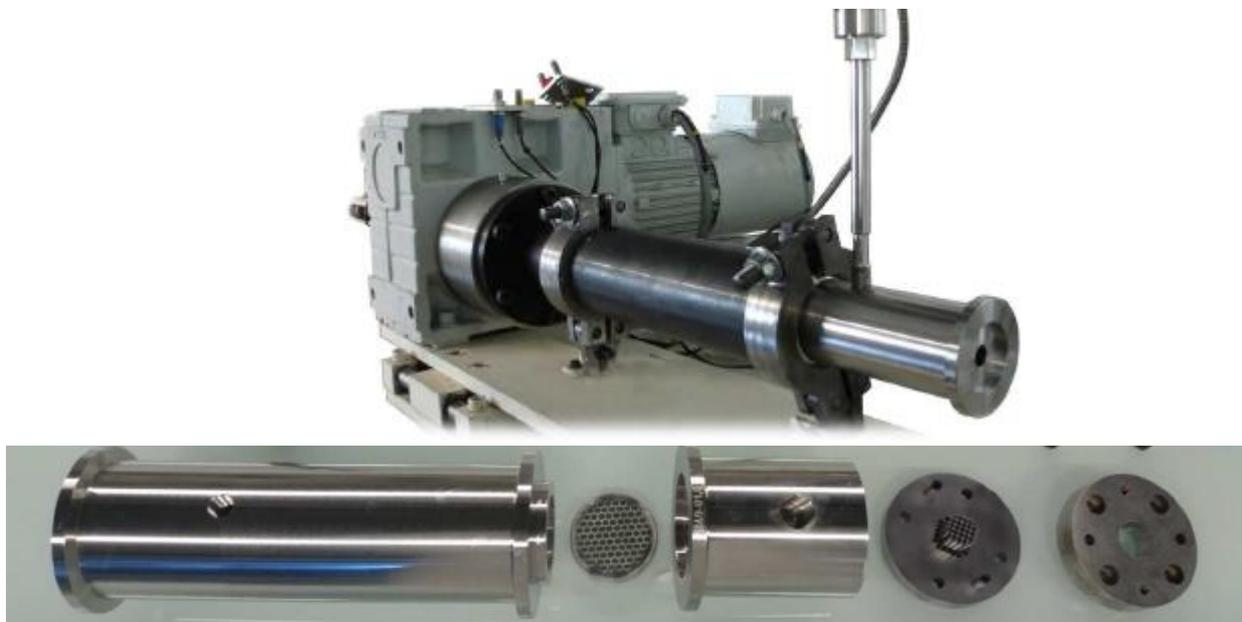
Figure 8 : Extrudeuse à piston
