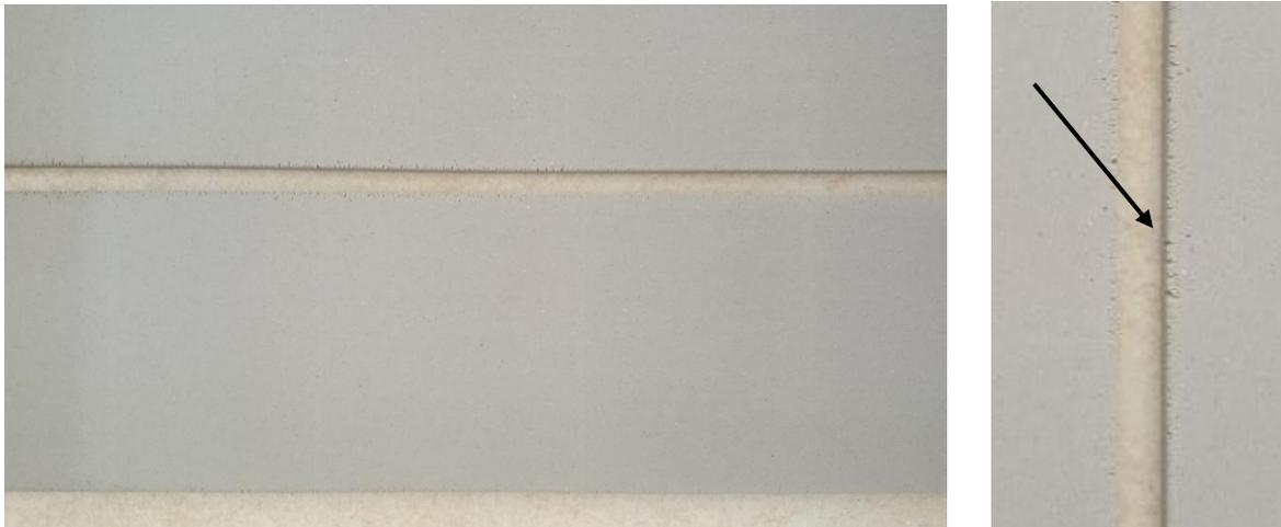
Figure 20 : Pâte contenant l'additif industriel 2 extrudée
