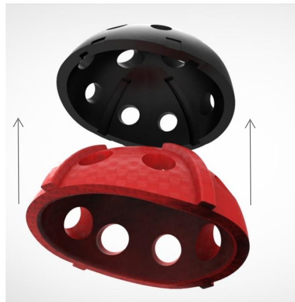
Ilustración 165. Ensamble Carcasa Intermedia – Carcasa Interior
