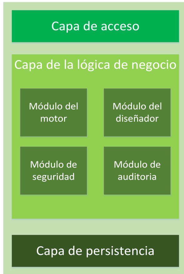
Figura 4.1: Esquema de la arquitectura de la API del motor.
