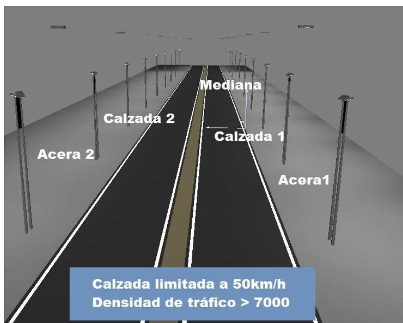
Figura 9.1. Geometría de la vía. Fuente: propia a partir del programa de cálculo luminotécnico Dialux.
