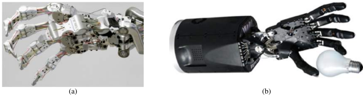
Figura 1: Ejemplos de manos antropomorfas robóticas: DLR Hand Arm system (a), Shadow Hand (b)
