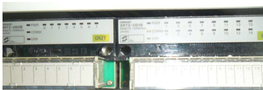
Imagen 78. Módulos de 8 y 16 salidas remotas de Omron (SRT2-OD08 y SRT2-OD16)
