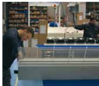
Montaje de cortinas de aire en la planta de Castellar del Vallès, Barcelona.
