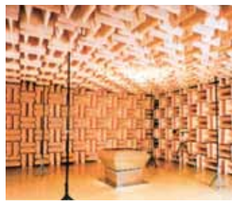
Cámara anecoica para medición de los niveles sonoros, según normas DIN 45635 parte 18.
