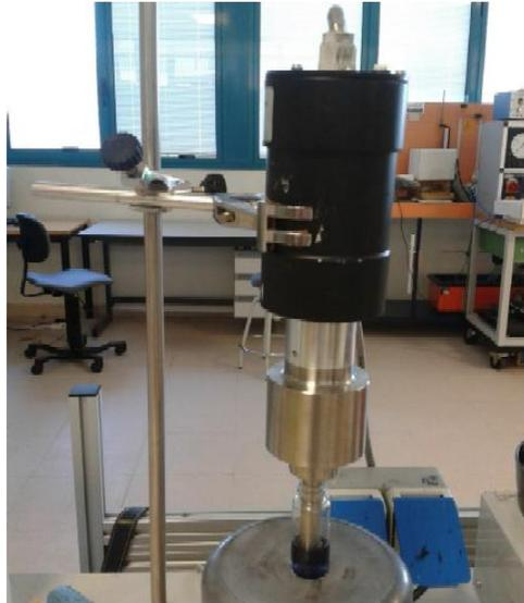
*Figura 20. Sonda de ultrasonidos Sonoplus HD2200D, Bandelin.*
