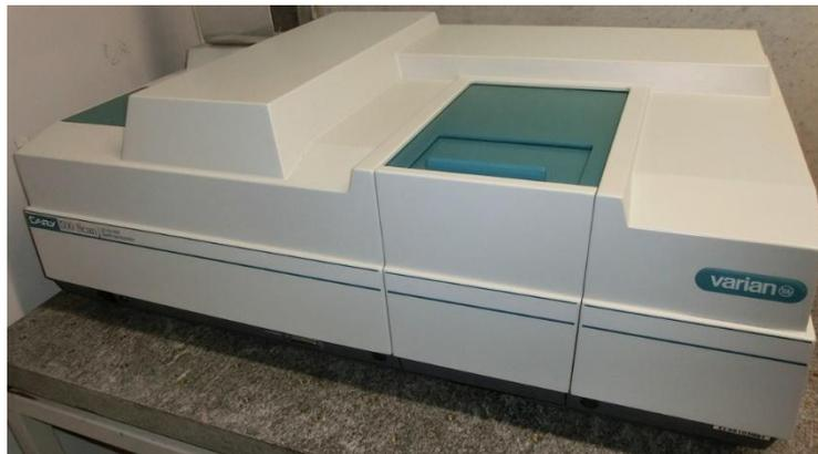
*Figura 10. Espectrofotómetro CARY 500.*
