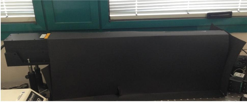
*Figura 13. Montaje caja negra cubriendo fuente de luz, portacubetas y detector.*
