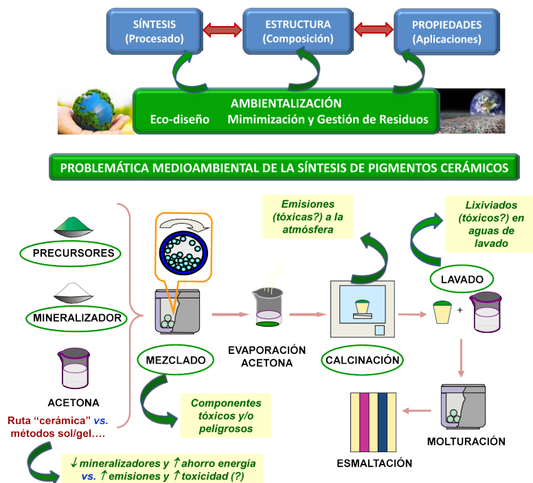
Figura 2. Trabajo “integral” de síntesis y caracterización de pigmentos cerámicos seguido en el laboratorio de Química del Estado Sólido de la UN (en verde los aspectos “ambientalizados”)
