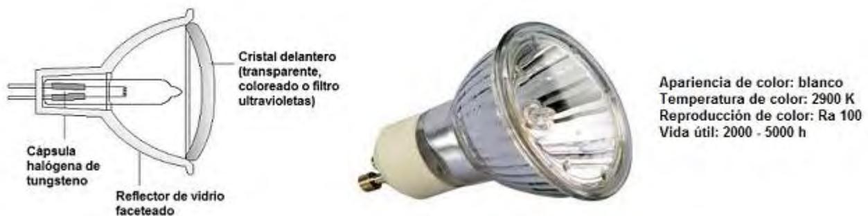
Fig. 4. Lámparas halógenas de tungsteno de baja tensión.
