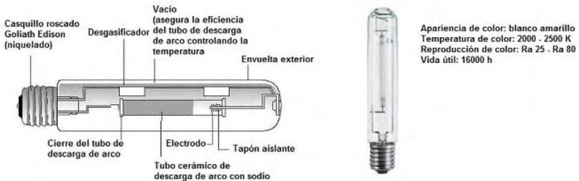
Fig. 6. Lámpara de sodio de alta presión.
