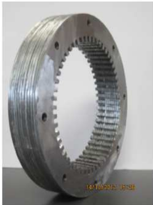
Figura 23: Estator del generador construido con chapa magnética.
