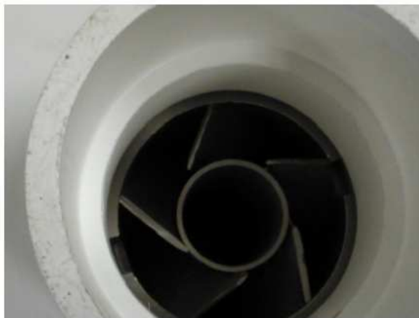
Figura 21: Álabes de la turbina desde la entrada del agua.
