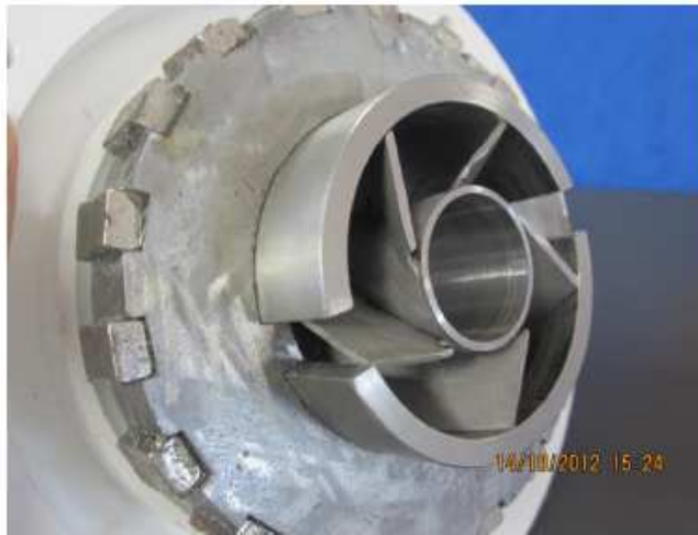
Figura 22: Detalle de los álabes y del núcleo magnético del rotor.
