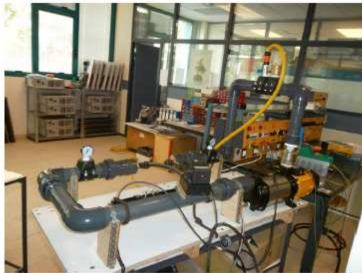
Figura 28: Vista del circuito 2 con una microturbina intercalada.
