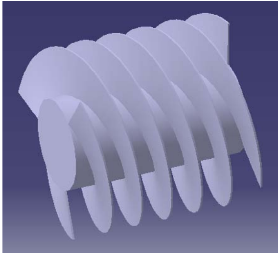
Figura 100: Rodete en forma de tornillo con una mayor separación entre las hélices.
