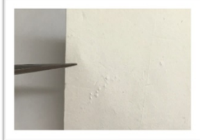
Fibers PHBV + 25 wt% \gamma -CD:OEO
